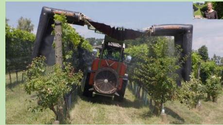
Abbildung 5 Einsatz eines Rebenschirms - Ausschnitt Farminar
